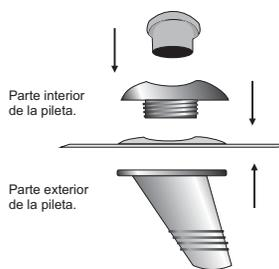
Para finalizar, ajustar firmemente los esquineros con los tornillos, colocar el pico de desagote ajustando fuertemente la rosca y presionando el tapón a fondo.
