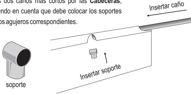
Una vez colocados los caños en las vainas e insertado los soportes, deberá poner los cuatro esquineros y proceder a levantar la piscina insertando los parantes, sin olvidar la colocación de sus respectivos regatones o base inclinada, según corresponda..
